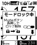
モードロックを解除するには、再度 Mode ボタンを長押ししてください。
